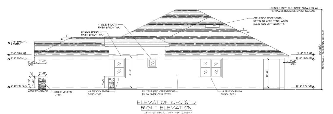
EXTERIOR ELEVATION LEFT AND RIGHT PAIRED VILLAS
